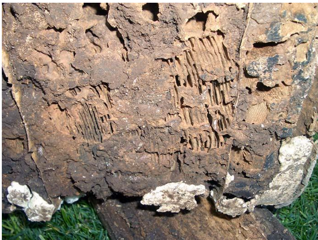
Madera de un jardín devorada especialmente por la parte en contacto con el suelo
